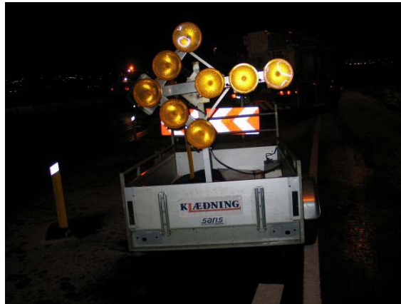
Blikkljós á stefnuör blikkuðu ekki. Geymirinn var rafmagnslaus
