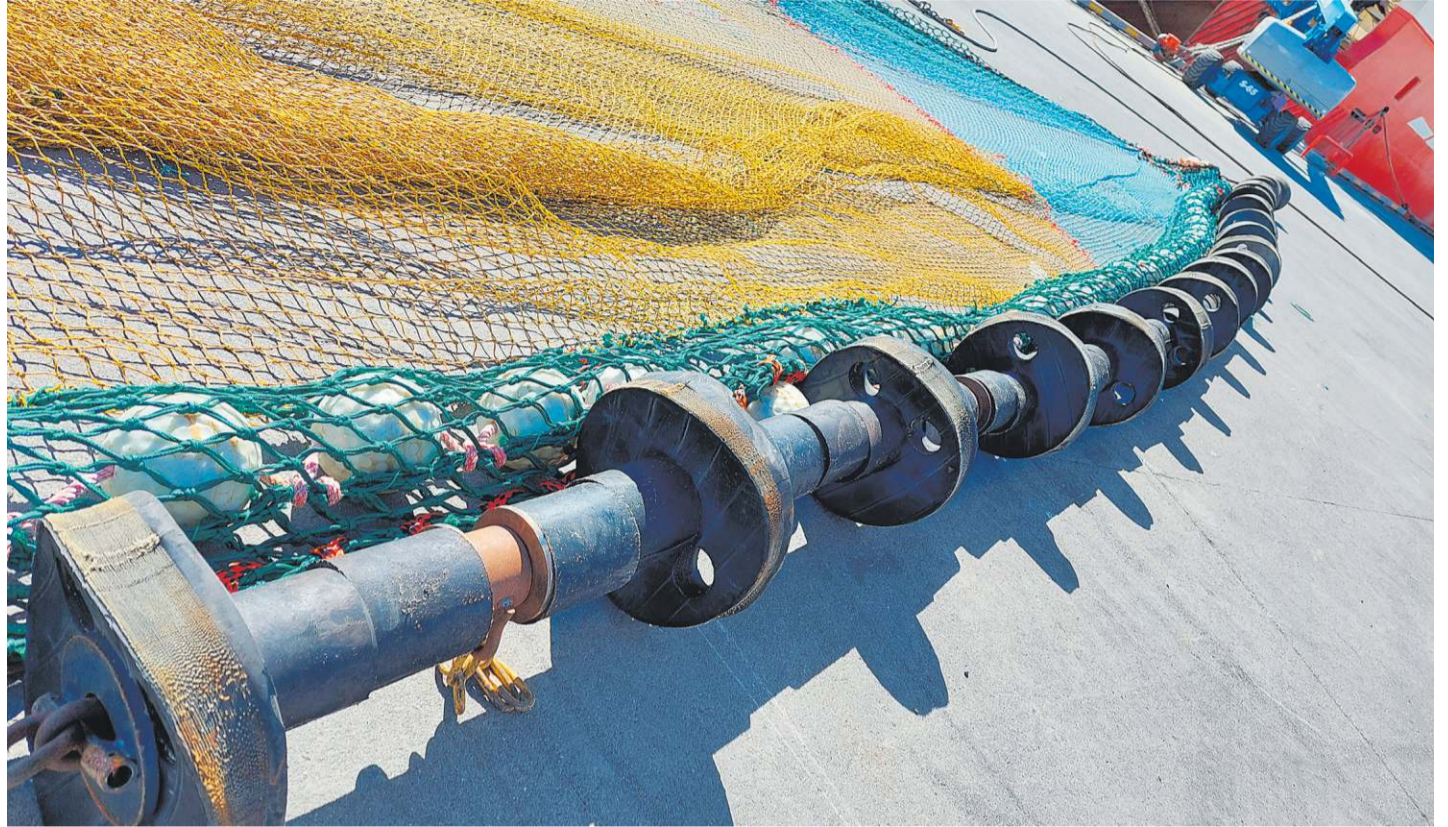
■ Rækjutroll Ísfells koma frá þjónustustöð fyrirtækisins á Húsavík. Þau notuð í Grænlandi, á Íslandsmiðum og í Barentshafi.
