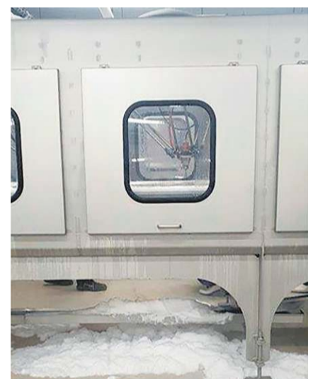
■ Próteinfroða safnast undir vatns-skurðarvél í fiskvinnslu.
